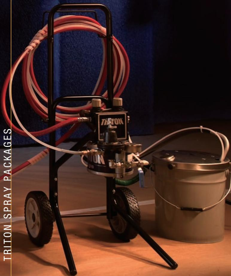
トライトンパッケージは、木材や金属部品に高品質な仕上げ塗装を施すためのエア駆動式ダイヤフラム・エアスプレーパッケージです。
