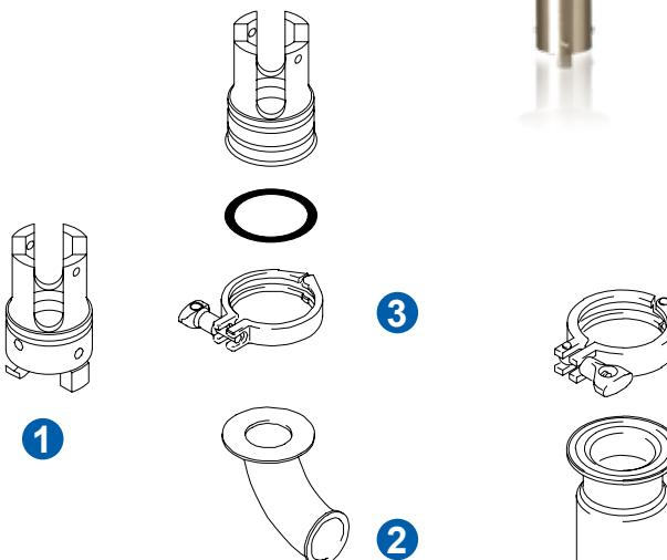
泵的进料口适合：插桶、管道、压盘式安装
