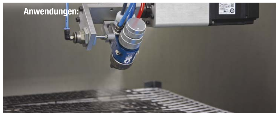
AirPro-EFX™-Automatik-Spritzpistole von Graco in einer automatisierten Anwendung mit Druckluftbetrieb.
