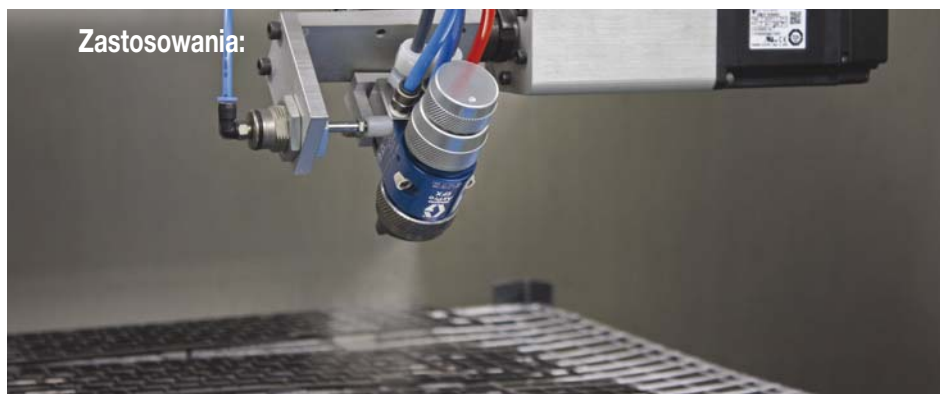
Zastosowanie automatyczne sterowane powietrzem pistoletu natryskowego Graco AirPro EFX™ Automatic Spray Gun.
