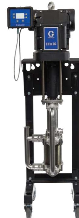
Im Gegensatz zu herkömmlichen Pumpen, die im Verbund betrieben und geregelt werden, arbeiten die Unterpumpen von Graco eigenständig. So kann sich die einzelne Pumpe mehrmals pro Sekunde an unterschiedliche Druck- und Durchflussanforderungen anpassen. Jede Pumpe kann auch allein betrieben werden, damit die Produktion auch während notwendiger Wartungsarbeiten aufrechterhalten werden kann. Ausstoßmengen bis zu 5000 cm<sup>3</sup> pro Zyklus.
