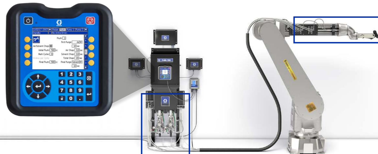
Strefy pulsacyjnego oczyszczania powietrzem/ rozpuszczalnikiem
