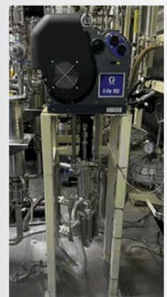
Bei elektrischen Pumpen wie der E-Flo DCi kommt es nie zu Vereisung. Das bedeutet, dass sich Bediener und Wartungspersonal im Farbmischraum keine Sorgen um Verunreinigungen oder Sicherheitsprobleme machen müssen, die durch Vereisung des Luftmotors verursacht werden.
