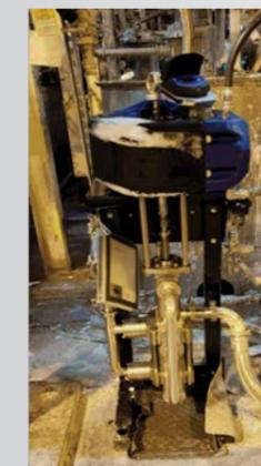
Vereisung tritt auf, wenn Feuchtigkeit in den Luftzuführleitungen kondensiert und an den pneumatischen Luftreglern gefriert. Wenn das angesammelte Eis in Materialbehälter schmilzt, kann es Verunreinigungen verursachen. Wenn das schmelzende Eis auf den Werksboden tropft, wird es zu einem Sicherheitsrisiko.
