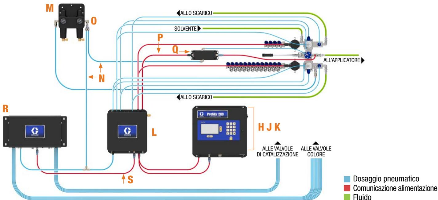
**4** Ordinare il modulo di controllo cambio colore necessario per gestire il processo di cambio colore e catalizzatore, esattamente come si farebbe con un sistema 2KS.
