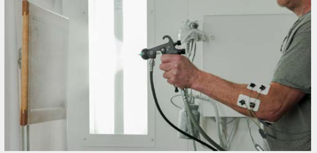
Gösterilen test, United States Ergonomics tarafından su püskürtme sırasında kas eforunun izlenmesini içermektedir.
