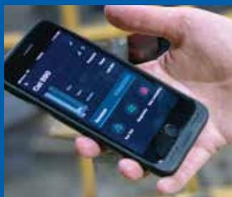
Le contrôleur GLC X utilise la technologie Bluetooth de sorte que les équipes de maintenance peuvent surveiller et contrôler une gamme étendue de paramètres de lubrification, comprenant par exemple les niveaux et pressions de lubrifiant, et évaluer rapidement l'état du système configuré.
