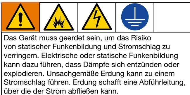
**Pumpe:** Erdungskabel und Klammer (im Lieferumfang enthalten) verwenden wie gezeigt in ABB. 2.
