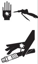
Spritzer aus der Spritzpistole bzw. dem Extrusionsventil, aus defekten Schläuchen oder gerissenen Bauteilen können Material in den Körper einspritzen und sehr schwere Verletzungen verursachen, die u. U. eine Amputation erforderlich machen. Ebenso kann Flüssigkeit, die in die Augen oder auf die Haut gelangt, schwere Verletzungen verursachen.
