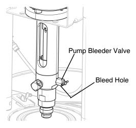
Fig. 6: Pump Bleeder Valve
