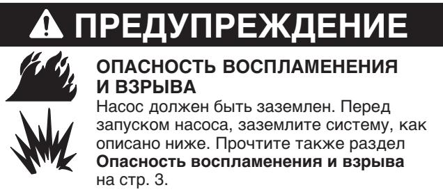
Чтобы снизить риск искрообразования от статического электричества, заземляйте насос и все другое оборудование, которое используется или располагается в зоне перекачивания. Смотрите местные электротехнические правила и нормы касательно подробных инструкций по заземлению для Вашей зоны и типа оборудования. **Заземляйте все такое оборудование.**
