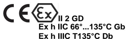
O código T da classificação ATEX depende da temperatura do líquido a ser bombeado. A temperatura do líquido é limitada pelos materiais dos componentes molhados no interior da bomba. Consulte Technical Data quanto à temperatura máxima de funcionamento do líquido para o modelo específico da sua bomba.
