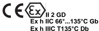
La classificazione in base alla codifica ATEX T dipende dalla temperatura del fluido pompato. La temperatura del fluido è limitata dai materiali delle parti umide interne alla pompa. Vedere Technical Data per la temperatura massima in esercizio del fluido, relativa al modello di pompa specifico.
