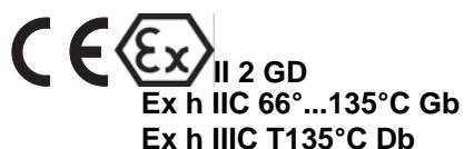
ATEX T kodu değeri, pompalanan akışkanın sıcaklığına bağlıdır. Akışkan sıcaklığı, pompanın içindeki ıslak parçaların malzemeleriyle sınırlanır. Sahip olduğunuz pompa modelinin maksimum akışkan çalışma sıcaklığı için bkz. Technical Data.
