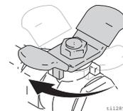
3. Pistole in einen geerdeten Metallbehälter richten und abziehen, um den Materialdruck zu entlasten.
