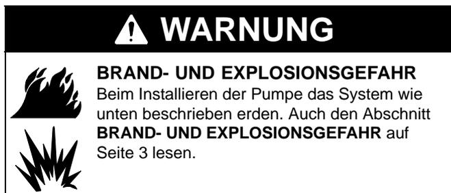
Um die Gefahr statischer Funkenbildung zu verringern, ist es notwendig, die Pumpe, das zu spritzende Objekt und alle anderen Spritz- bzw. Extrusionsgeräte, die verwendet werden oder sich im Arbeitsbereich befinden, zu erden. Örtliche Vorschriften zur richtigen Erdung der Geräte beachten.
