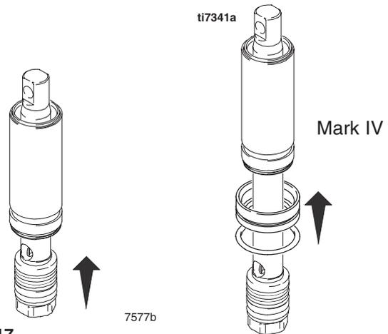
Fig. 18. Engrase los 2,5 a 5 cm de la parte superior del vástago del pistón que pasarán a través de las empaquetaduras del collarín del cilindro.
