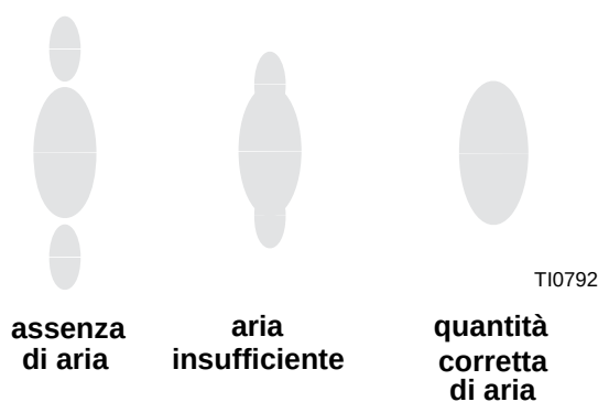
FIG. 11: Getto di spruzzatura corretto
