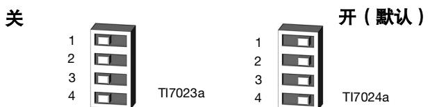
图 10 点拨式开关 (SW2) 的设置
