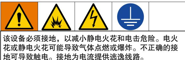
**Reactor E-10:** 通过电源线接地。
