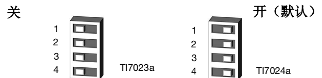
图 10 点拨式开关（SW2）的设置
