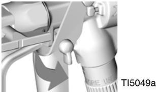
2. Chiudere la valvola dell'aria del tipo a spurgo (B).
