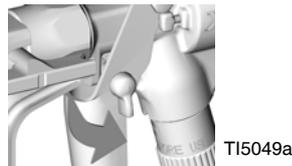
6. Scaricare il fluido. Per scaricare il fluido, aprire lentamente tutte le valvole del fluido, compresa la valvola di scarico/spurgo (J), del sistema e scaricare il fluido in un secchio. Se è presente un tubo di ritorno, aprire la valvola a sfera sulla linea di ritorno. Dopo aver drenato il fluido, chiudere la/le valvola/e.
