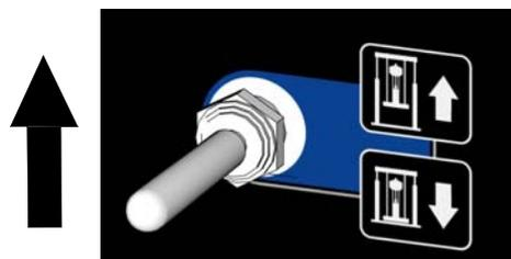
3. Медленно поворачивайте регулятор перемещения плунжера ВВЕРХ (N) по часовой стрелке, пока плунжер не начнет подниматься, см. Рис. 19.
