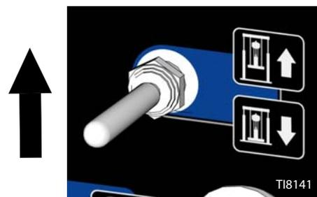
3. Когда плунжер достигнет нижнего положения, установите рычаг перемещения плунжера ВВЕРХ/ВНИЗ в центральное положение (выключение).
