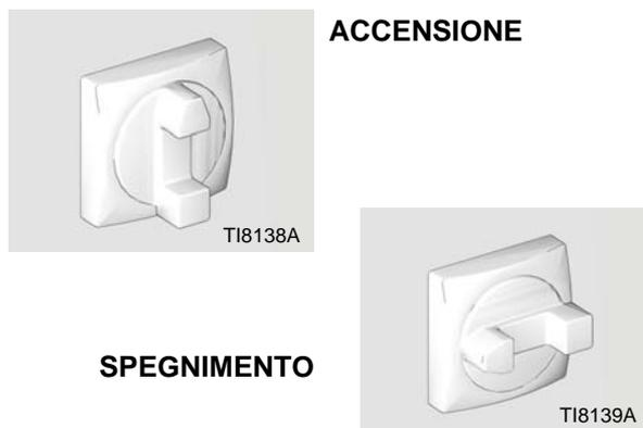
**FIG. 6: Disconnessione alimentazione elettrica principale**
