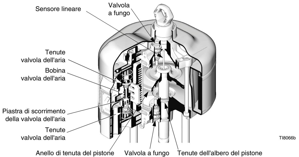
**FIG. 7. Vista sezionata, Modelli con sensore lineare**
