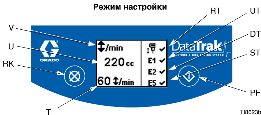
Рис. 3. Устройства управления модулем DataTrak и их индикаторы
