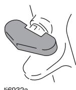
5. Povucite okidač sa pištoljem usmerenim u uzemljenu metalnu kofu.
