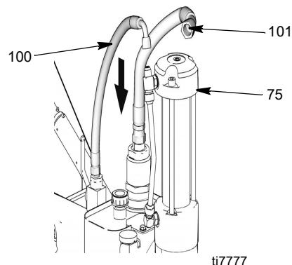
4. Norëdami paðalinti orà ið hidraulinio þarno padidinkite slégá tiek, kad hidraulinis variklis pradëto veikti ir leiskite skysèiui tekëti 15 sekundþiø. Sumaþinkite slégá. Pasukite pripildymo voþtuvà á horizontalià padëtâ (uþdaryta).
