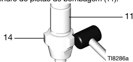
5. Pressionar esfera de admissão (16) a partir da parte superior da câmara de entrada (14) (tenha em atenção em não danificar o encaixe(18) para remover a toda a câmara de entrada montada).
