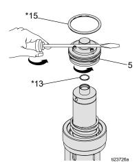
Fig. 12 Series B Air Valve
