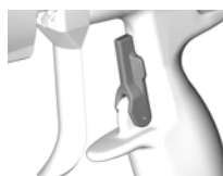
Spoušť odjistěna (stříká)
