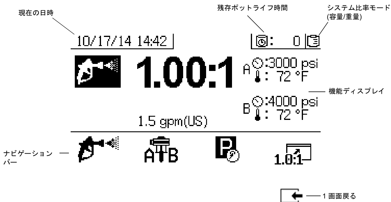
図 6: メインディスプレイ画面のコンポーネント (すべてのディスプレイ機能が有効の状態でご示)
