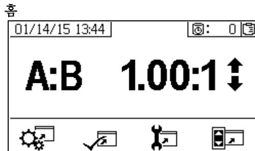
홈은 설정 모드에 처음으로 표시되는 화면입니다. 여기에는 현재 계량 펌프 비율이 표시되며, 이 화면을 통해 사용자가 혼합 비율을 변경하거나 다음과 같은 화면에 액세스할 수 있습니다. 시스템 설정, 기능 활성화/비활성화, 유지보수 설정 및 한계. 자세한 내용은 다음 표를 참조하십시오.
