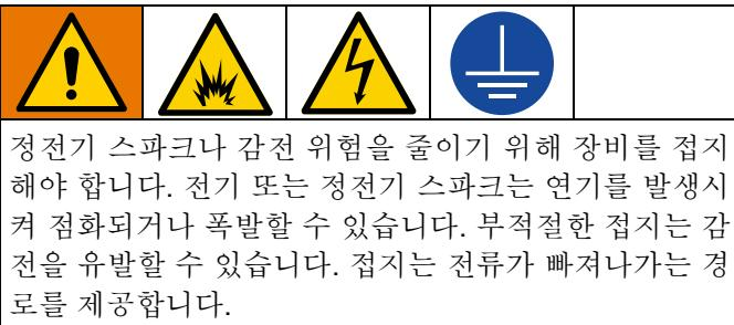
**시스템:** 전원 연결(27페이지)에 설명된 바과 같이 전기 구획에 전원 접지선을 연결하십시오. XM 도장기 접지선 클램프(FG)를 실제 접지면에 연결하십시오.
