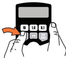
b. Drücken Sie die Taste Automatik/Zurücksetzen und halten Sie diese niedergedrückt, um die Null (0) Dosierungseinheiten zu speichern. Das Menü für Dosierungseinheiten zeigt an.
