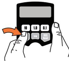
2. Drücken Sie die Tasten für Manuelle Zurücksetzung und Automatische Zurücksetzung gleichzeitig und halten Sie diese Tasten während ungefähr sechs (6) Sekunden niedergedrückt, um die Einrichtungsmenüs einzugeben.
