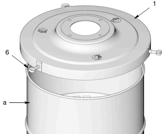
Рис. 4: Показана крышка для резервуара на 120 фунтов
