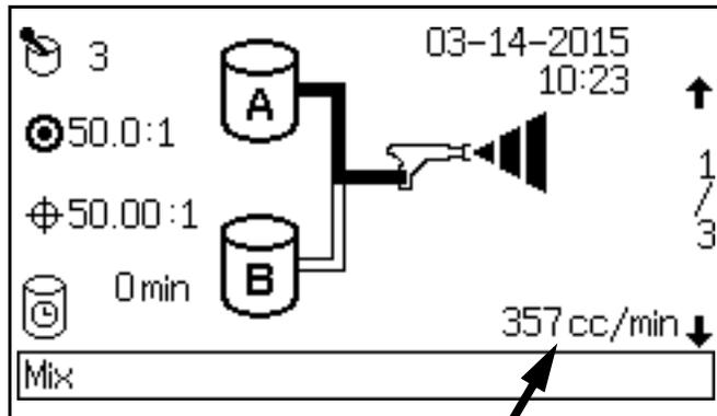
그림 63. 상태 화면 유량 표시
