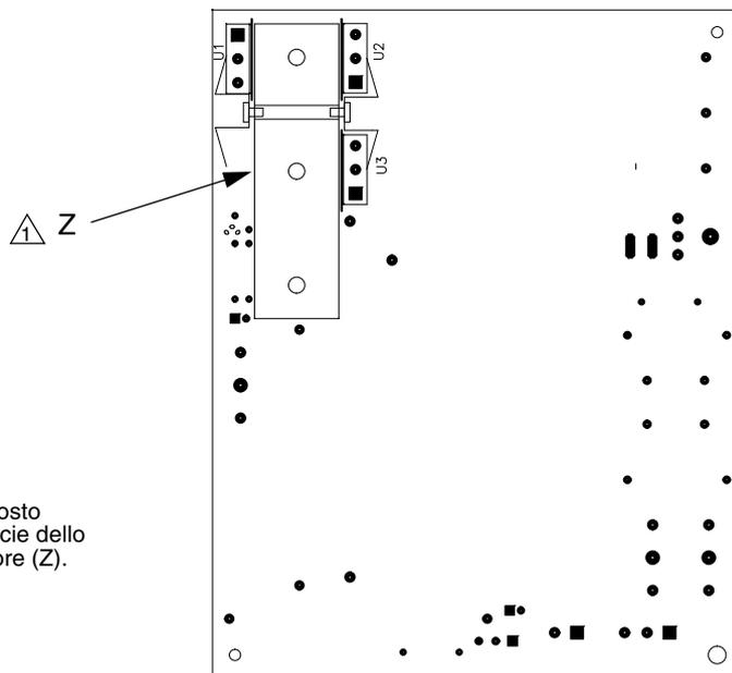
⚠ Applicare un composto termico alla superficie dello scambiatore di calore (Z).
