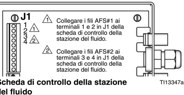
FIG. 18 Manutenzione del flussostato aria
