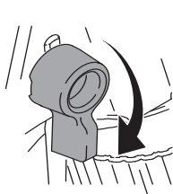
Abzugssperre entriegelt (Pistole spritzt)
