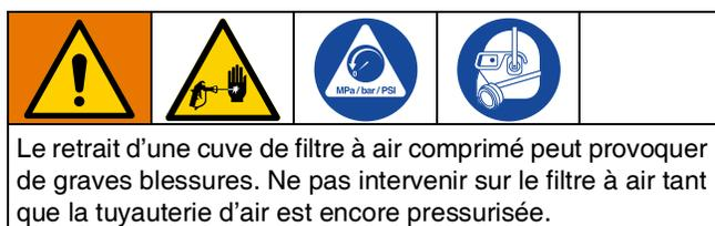
Le retrait d'une cuve de filtre à air comprimé peut provoquer de graves blessures. Ne pas intervenir sur le filtre à air tant que la tuyauterie d'air est encore pressurisée.
