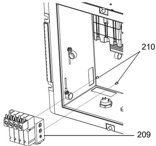
7. Das Magnetventil (209) entfernen und austauschen.
