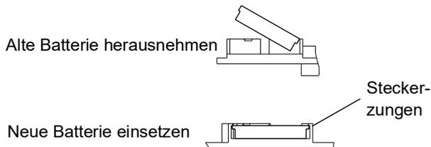
3. Die Batterie durch eine neue Batterie ersetzen. Sicherstellen, dass die Batterie unter die Steckerzungen passt, bevor das andere Ende durch Drücken in die richtige Stelle einrastet.
