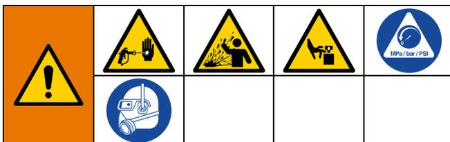
Dieses Gerät bleibt unter Druck, bis der Druck manuell entlastet wird. Um ernsthafte Verletzungen durch Eindringen von unter Druck stehendem Material in die Haut, durch Verschütten von Material und durch bewegliche Teile zu vermeiden, die Vorgehensweise zur Druckentlastung nach Abschluss des Spritzvorgangs sowie vor der Reinigung, Prüfung oder Wartung des Geräts befolgen.
