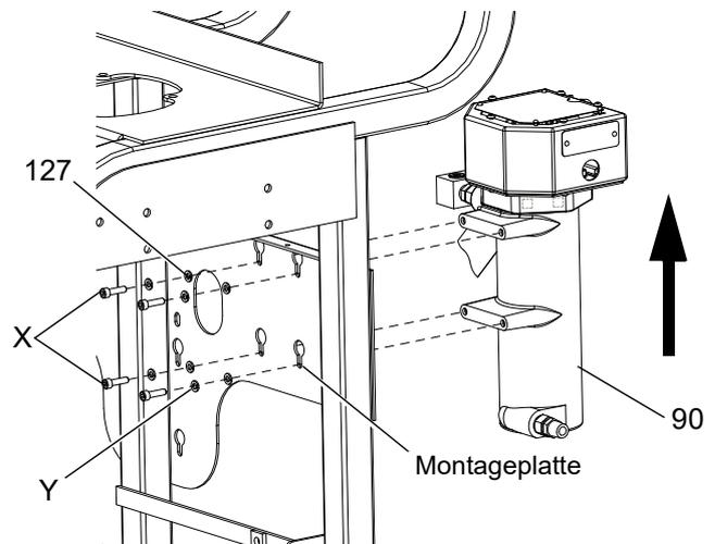
3. Die Heizung austauschen. Zum Einbau einer neuen Heizung die Schritte in umgekehrter Reihenfolge durchführen.
