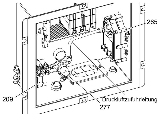
5. Die Schwenkverbindung des Luftreglers (276) lösen und vom Magnetventilmodul (209) abnehmen.
