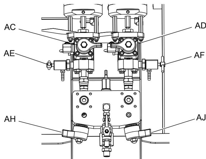
10. Schließen Sie die Mischverteilterventile (AH, AJ).
