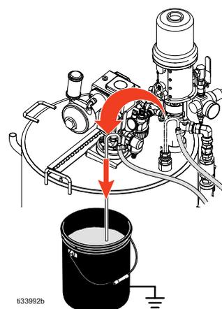
6. Öffnen Sie die Rücklaufventile (AC, AD).
