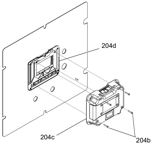
6. Die hintere Platte des Anzeigegeräts (204c) entfernen und die Anzeigegeräte-kabel und das Hauptschalterkabel (239) von der Platine trennen.
