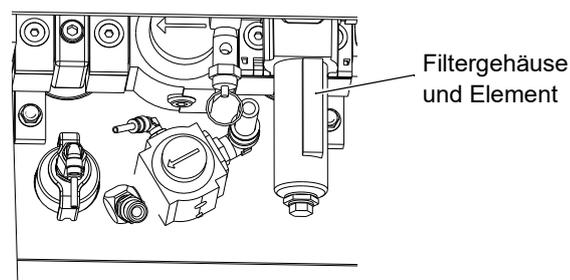
5. Das Filtergehäuse fest aufschrauben.
