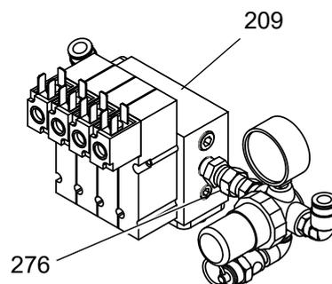
6. Die Teile des Generatorreglers je nach Bedarf reparieren oder austauschen. Siehe **Generatorbaugruppe**, Seite 84, für Reparaturteile. Die Schwenkverbindung des Luftreglers (276) austauschen.
