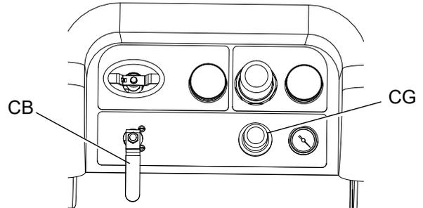
5. Abzugssperre entriegeln. Halten Sie ein Metallstück der Spritzpistole fest gegen einen geerdeten Eimer mit einem Spritzschutz. Verwenden Sie einen Eimer mit einem Deckel mit einer Bohrung, durch den eine Ausgabe erfolgen kann. Achten Sie darauf, Ihre Finger von der Vorderseite der Pistole fernzuhalten. Nun den Abzug der Spritzpistole betätigen, bis sauberes Lösungsmittel austritt.
