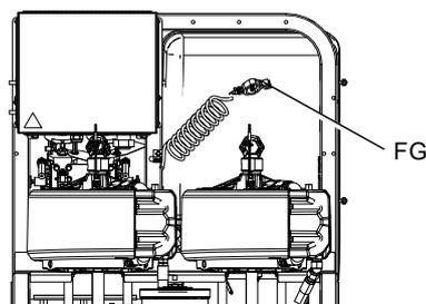
**Luft- und Materialschläuche:** Verwenden Sie nur elektrisch leitende Schläuche mit einer Schlauchgesamtlänge von maximal 152 m (500 ft), um eine kontinuierliche Erdung zu gewährleisten. Den elektrischen Widerstand der Schläuche regelmäßig prüfen. Wenn der Gesamtwiderstand gegen Erde über 29 Megaohm liegt, muss der Schlauch sofort ausgetauscht werden.
