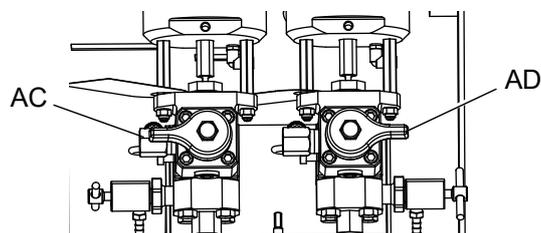
7. Öffnen Sie das Luftventil der Zufuhrpumpe (EM) und beginnen Sie, Material aus dem Materialbehälter zu pumpen. Die Zufuhrpumpe kann zum Stillstand kommen.
