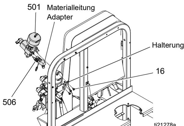
6. Die Dosierventile ausbauen. Siehe Wartungs- und Reparaturanweisungen im Dosierventil-Handbuch.
