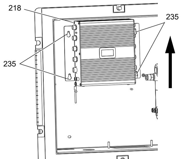
6. Das FCM nach oben und aus den schlüssellochförmigen Schlitzen schieben.
