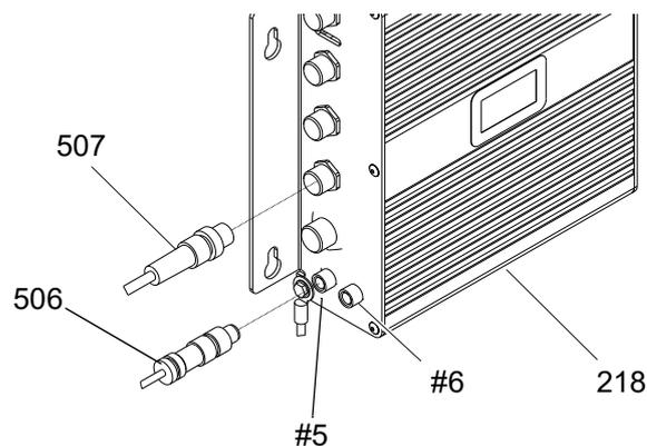
5. Den Widerstandstemperatursensor (506) von der Zugentlastung abnehmen.
