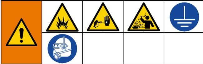
Um Brände und Explosionen zu vermeiden, Gerät und Abfallbehälter immer erden. Um statische Funkenbildung und Verletzungen durch Spritzer zu vermeiden, immer mit dem kleinstmöglichen Druck spülen.
