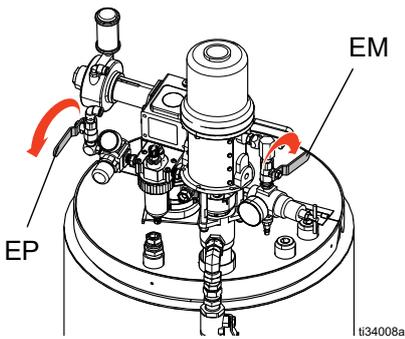
11. Lassen Sie die Haupthochdruck-Materialpumpen laufen, bis das Material aus dem System entleert
