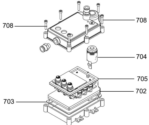
10. Dichtung (702) und/oder Platinenbaugruppe (705) austauschen, falls beschädigt.
