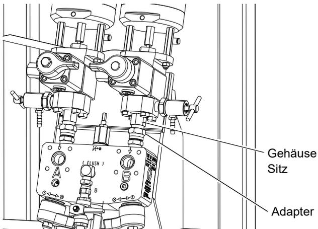
5. Den Widerstandstemperatursensor (506) von der Zugentlastung lösen. Drucksensor (507) und Materialleitungsadapter von jedem Dosierventil (501) lösen.
