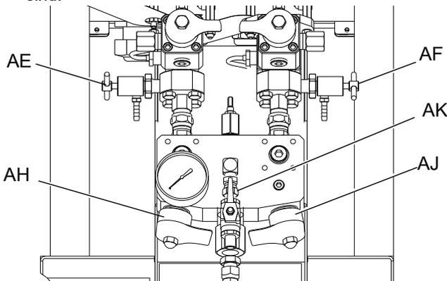
3. Öffnen Sie das Lösungsmittelabsperrventil (AK) am Mischverteiler.
