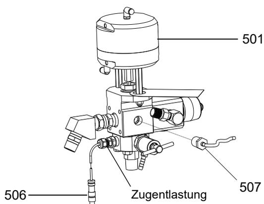
6. Gegen einen neuen Materialdrucksensor austauschen und den Drucksensor am FCM anschließen.
