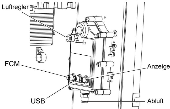
6. Die Luftleitung des Luftreglers und die Abluftleitung lösen.
