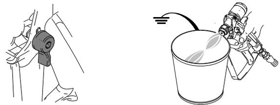
6. Schließen Sie das Lösungsmittelpumpen-Luftventil (CB).
