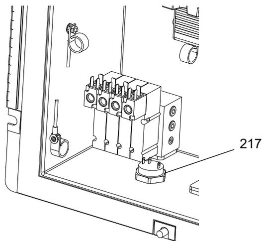
6. Neues Alarmmodul anschrauben. Die Alarmkabel wieder anschließen. Siehe **Teile**, Seite 59.
