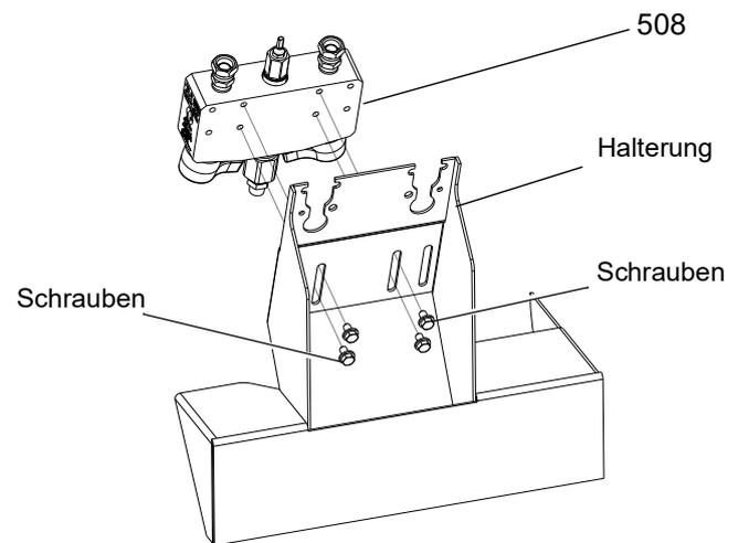
4. Die Dosierventilgehäusesitze von den Adaptern am Mischverteiler losschrauben.
