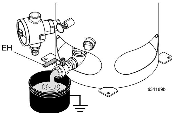
13. Schließen Sie den Materialablauf (EH) und füllen Sie den Materialbehälter mit Lösungsmittel.
