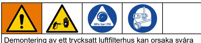
Demontering av ett trycksatt luftfilterhus kan orsaka svåra skador. Utför inte service av luftfilter förrän trycket i luftledningen avlastats.
