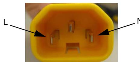
**FIG. 15: Spinotti terminali del riscaldatore**
