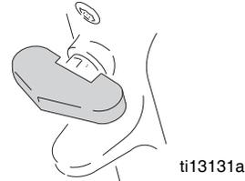
2. 关闭通 / 断开关并将压力控制旋钮逆时针旋到底。
