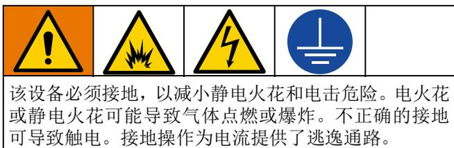
**Reactor:** 通过电源线接地。
