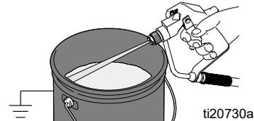
15. Griff gegen den Uhrzeigersinn drehen, um das Entlüftungsventil zu öffnen.
