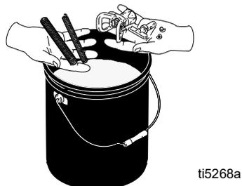
5. Siphonschlauch-Gruppe aus dem Farbbehälter nehmen und in die Spülflüssigkeit legen. Wasser für Farbe auf Wasserbasis und Terpentinersatz für Farbe auf Ölbasis verwenden.
