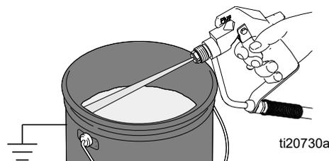
11. Griff gegen den Uhrzeigersinn drehen, um das Entlüftungsventil zu öffnen. Spülflüssigkeit etwa 20 Sekunden lang zirkulieren lassen, um den Ablassschlauch zu reinigen.
