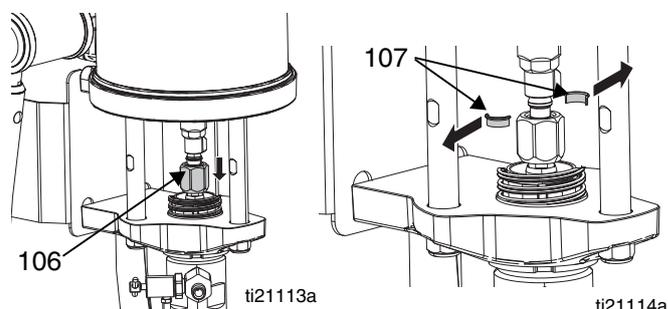
6. Utilisez un marteau et une tige en laiton pour desserrer le contre-écrou (105). Dévissez autant que possible le contre-écrou.
