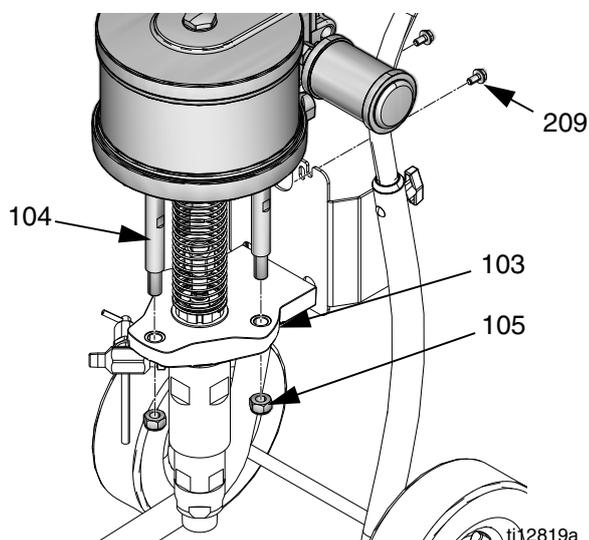
7. Utilisez une douille sur les méplats des barres d'accouplement (104) pour les retirer du capot inférieur du moteur pneumatique.
