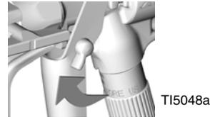
7. Pulvériser un jet d'essai. Réglez la pression comme nécessaire. Lisez les recommandations du fabricant.
