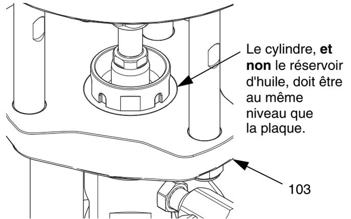
**FIG. 6 : Alignez le cylindre et la plaque d'adaptateur.**
