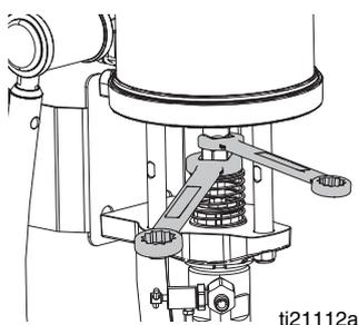
5. Abaissez suffisamment l'écrou de serrage (106) pour retirer les colliers d'accouplement (107) et puis retirez l'écrou de serrage (106).
