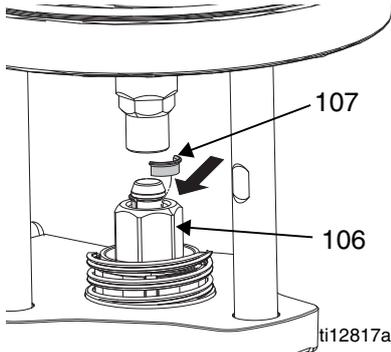
4. Placez le ressort (118) sur l'écrou de serrage (106). Maintenez le ressort vers le bas pour connecter la tige du moteur pneumatique et l'écrou de serrage (106).
