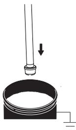
**REMARQUE** : n'étirez pas le flexible ; laissez-le pendre pour laisser le fluide s'écouler dans la pompe.
