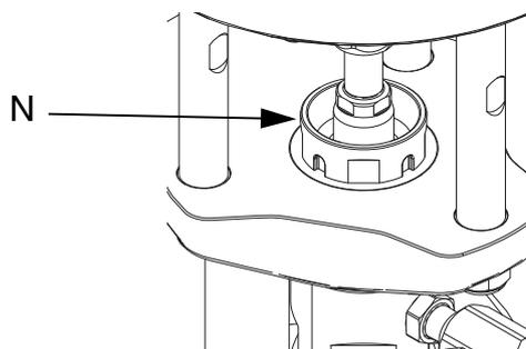
**FIG. 4 : Réservoir d'huile**
