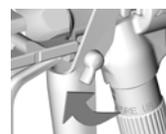
b. ガンをゆっくりとトリガーして、ポンプが循環し始めるまで、レギュレーターの調整ノブ (E) を開きます。ガンから安定した流れが出るまで接地された缶にガンをトリガーします。
