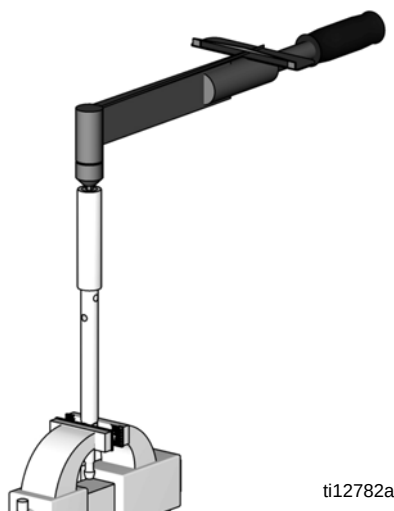
FIG. 2. Ta bort genomflödesmuttern
